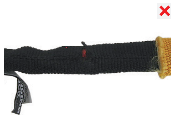
narušená konstrukce popruhu
